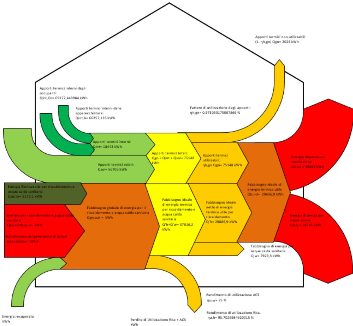
Dall'analisi dei diagrammi di Sankey relativo al fabbisogno termico dell'edificio post intervento è possibile notare che il rendimento di utilizzazione del riscaldamento aumenta, mentre si riducono gli apporti termici solari. L'energia dispersa per ventilazione e trasmissione invece non diminuisce.
