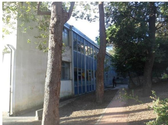
Il profilo termico della struttura è dovuto in gran parte alla sua morfologia: pareti e copertura non isolate, serramenti poco performanti.
